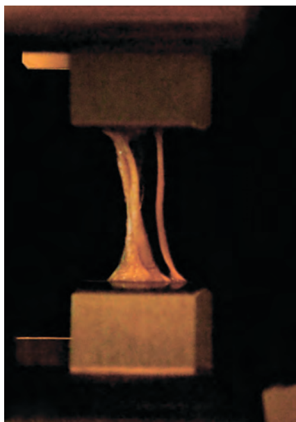
Рис. 7. Определение прочности на разрыв, сухожилий подошвенной мышцы, сложенной в 4 раза.
