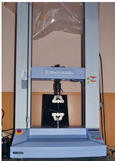
Рис. 6. Определение силы, необходимой для разрыва нити Полиэстер № 6.
