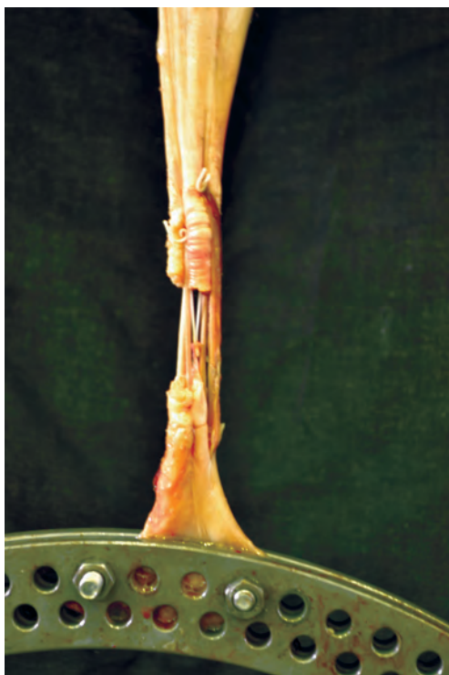
Рис. 8. Определение максимальной нагрузки для пяточного сухожилия, восстановленного по предлагаемой методике.
