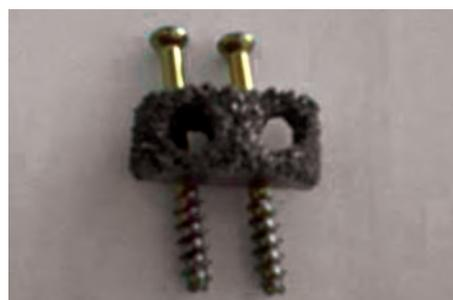
**Рис. 2.** Вид готового для установки трансплантата из пористого никелида титана.
