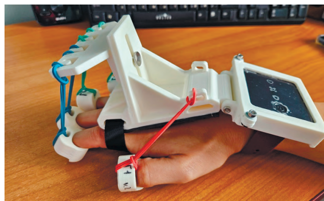
РИС. 1. Медицинский тренажер «Перчатка» для коррекции спастичности верхней конечности
