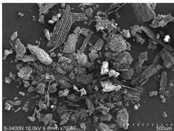
Рис. 2. Взвесь природных минералов из образца снега, собранного в районе железнодорожного переезда (станция 1). Сканирующая электронная микроскопия во вторичных электронах. Ув. × 70.
