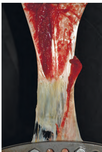
Рис. 4. Определение силы и максимальной степени растяжения, при которой происходит разрыв.
