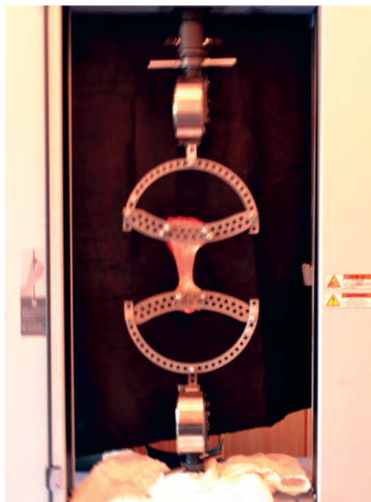
Рис. 3. Препарат, установленный в динамометр.
